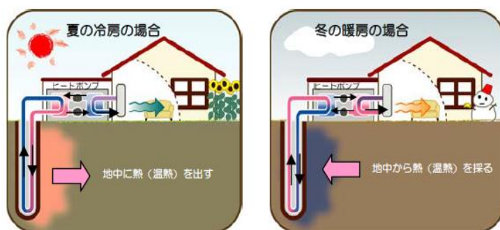
図 地中熱利用ヒートポンプの仕組み（地中熱利用にあたってのガイドライン、環境省）
