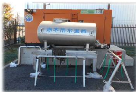
【写真 2-4 車載用アルミ製水槽】
