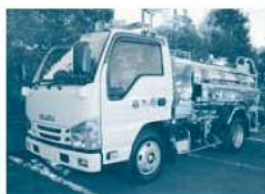
▲新しく導入した加圧式給水車 ▲応急給水装置を給水車に取り付けての使用も可能です
